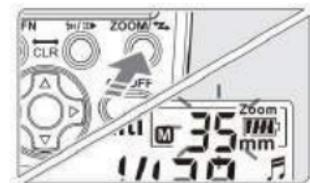
Ручная установка угла освечивания вспышки: Нажмите кнопку **<ZOOM>** кратко, когда на ЖК-дисплее отображается [ **M** ], то можно установить угол вручную (24, 28, 35, 50, 70, 80, 105мм).
