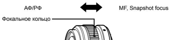
Механизм фокусировки Snapshot focus позволяет фокусироваться с помощью фокального кольца по съемочному расстоянию. Фотоаппарат фокусируется на глубине резкости, соответствующей установленному значению диафрагмы.
