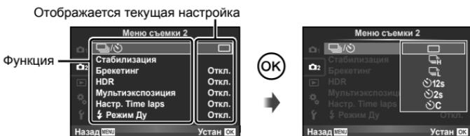
4 С помощью  $\Delta$   $\nabla$  выделите нужный параметр и нажмите **OK**, чтобы выбрать его.
