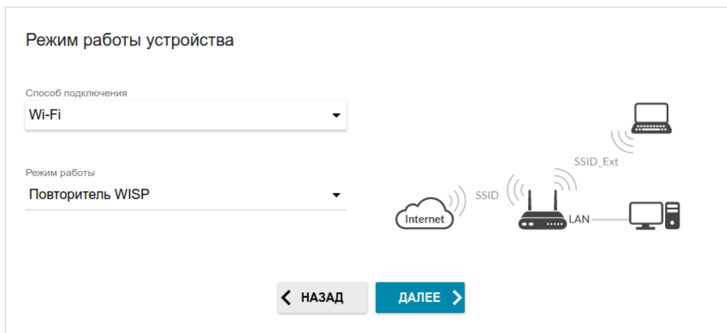
Рисунок 35. Выбор режима работы устройства. Режим Повторитель WISP .
