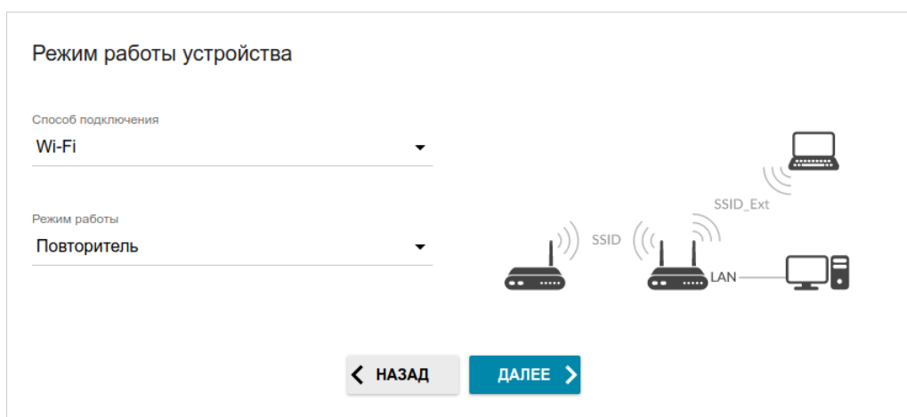
Рисунок 37. Выбор режима работы устройства. Режим Повторитель .
