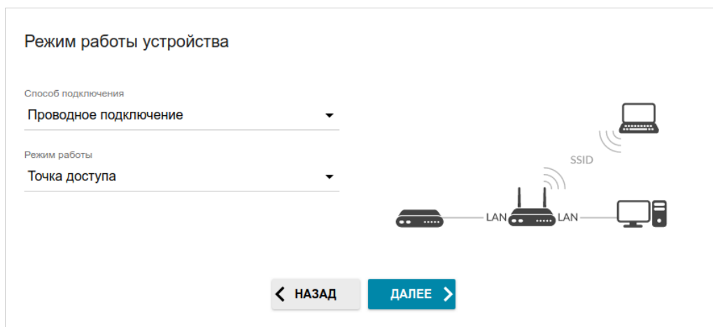
Рисунок 36. Выбор режима работы устройства. Режим Точка доступа .
