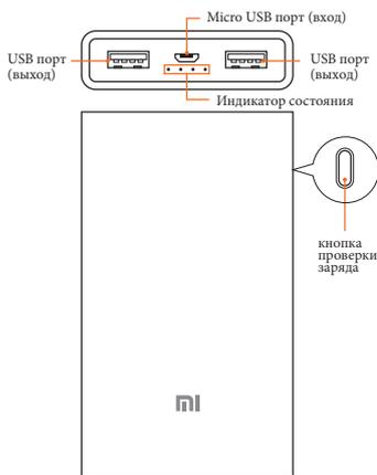
Примечание: Кнопка «Проверка уровня заряда» не предназначена для включения/выключения устройства, в устройстве есть автоматическое определение зарядки или разрядки, поэтому нет необходимости постоянно нажимать кнопку «Проверка уровня заряда». За две минуты до разрядки индикатор заряда аккумулятора выключится
